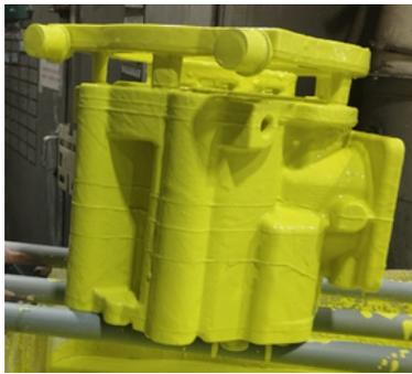
En collaboration avec notre principal client du lost foam et notre fournisseur d'enduit, nous avons réalisé des essais pour réduire les actions de trempage de nos blancs
